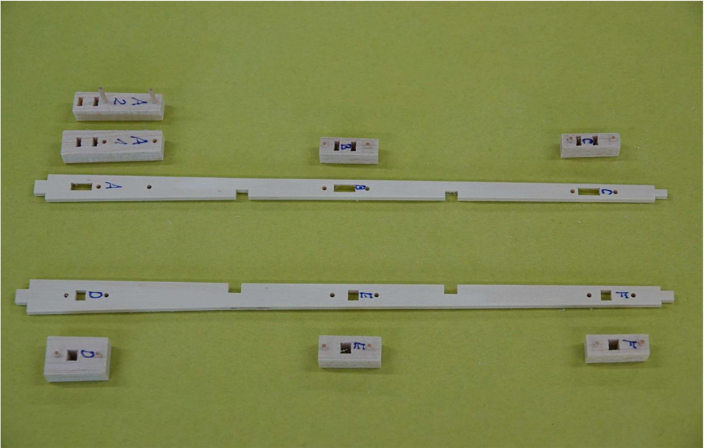
2mm Dübel zuerst in die Balsaverstärkungen kleben
