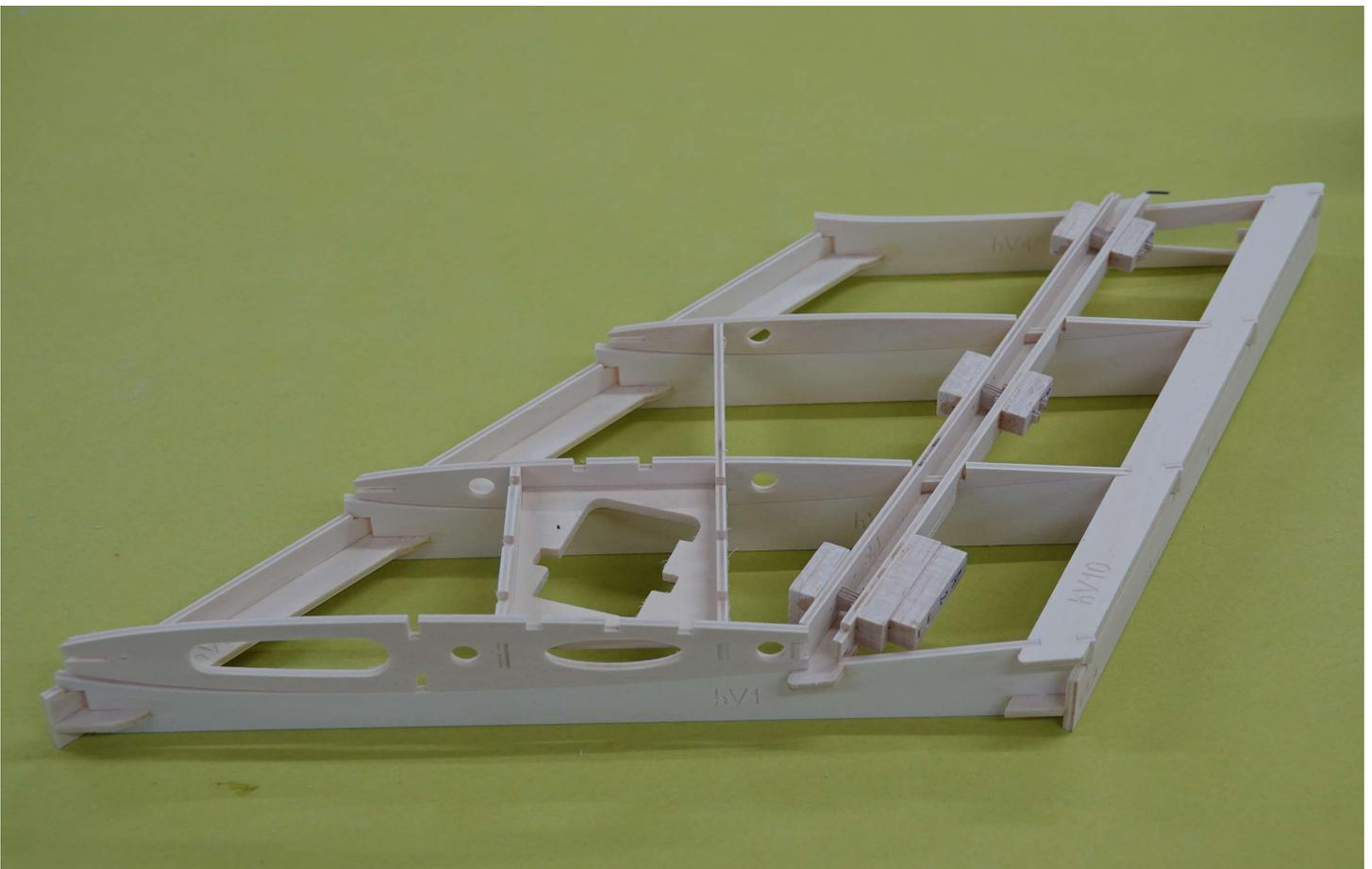
Zum Kleben des Seitenleitwerk der 1.2mm Stahldraht aus den Scharnieren entfernen. Unbedingt darauf achten, dass kein Leim in die Scharniere gelangt.
