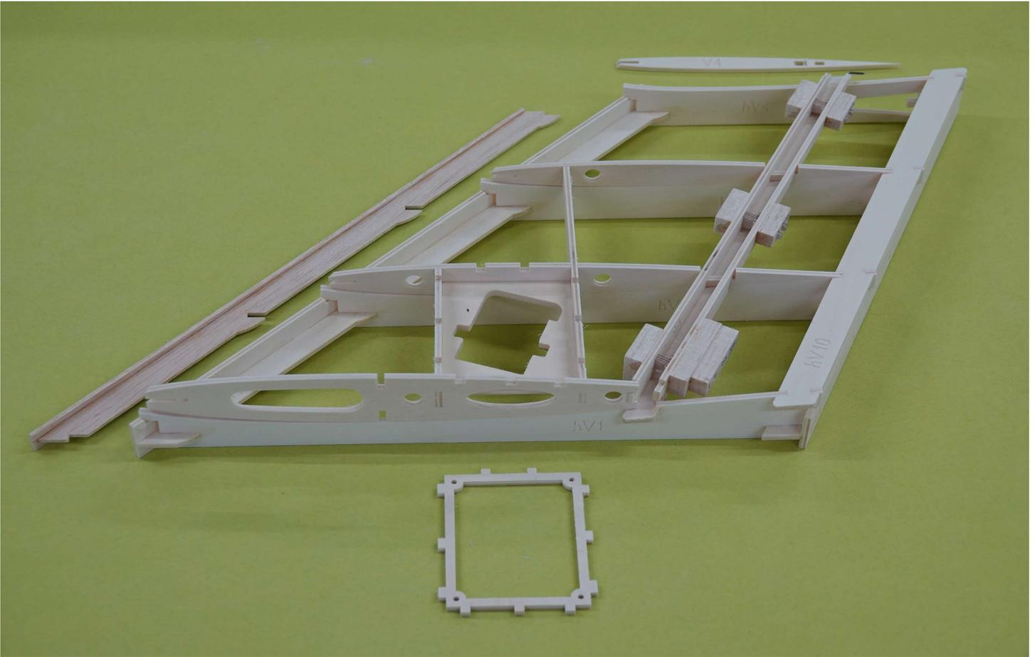
Um ein Festkleben vom Flügel mit dem Heling zu verhindern, den Heling mit Klebeband abdecken
